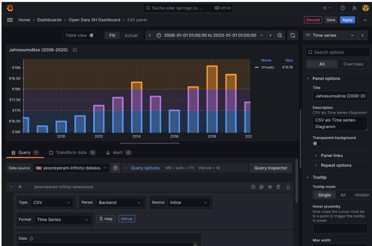
Abbildung 2: Beispiel eines Panels vom Visualisierungstyp „Time series“
